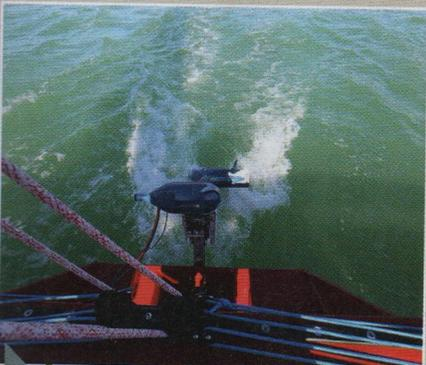
**Pas pratique** Sous voiles, l'embase du moteur électrique traîne dans l'eau même relevée. Dommage!
